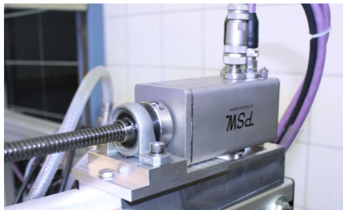
Abb. 2: Eines der Positioniersysteme PSW am Prüfstand am Wissenschaftszentrum Weihenstephan
