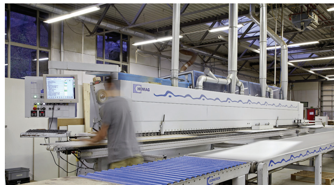
Abb. 4: Die Kantenanleimmaschine von HOMAG, seit vielen Jahren im einwandfreien Einsatz bei Becherer
