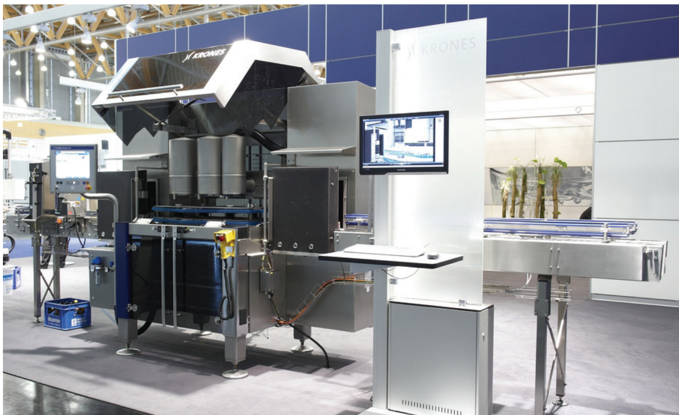
Abb. 1: Anlage zur Leerflaschen-Inspektion - die KRONES Linatronic 735
