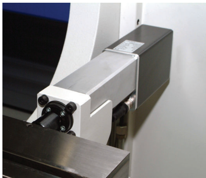
Abb. 3 a und b: Das lineare Positioniersystem LPE von halstrup-walcher. Links vorne sieht man die Matrize.
